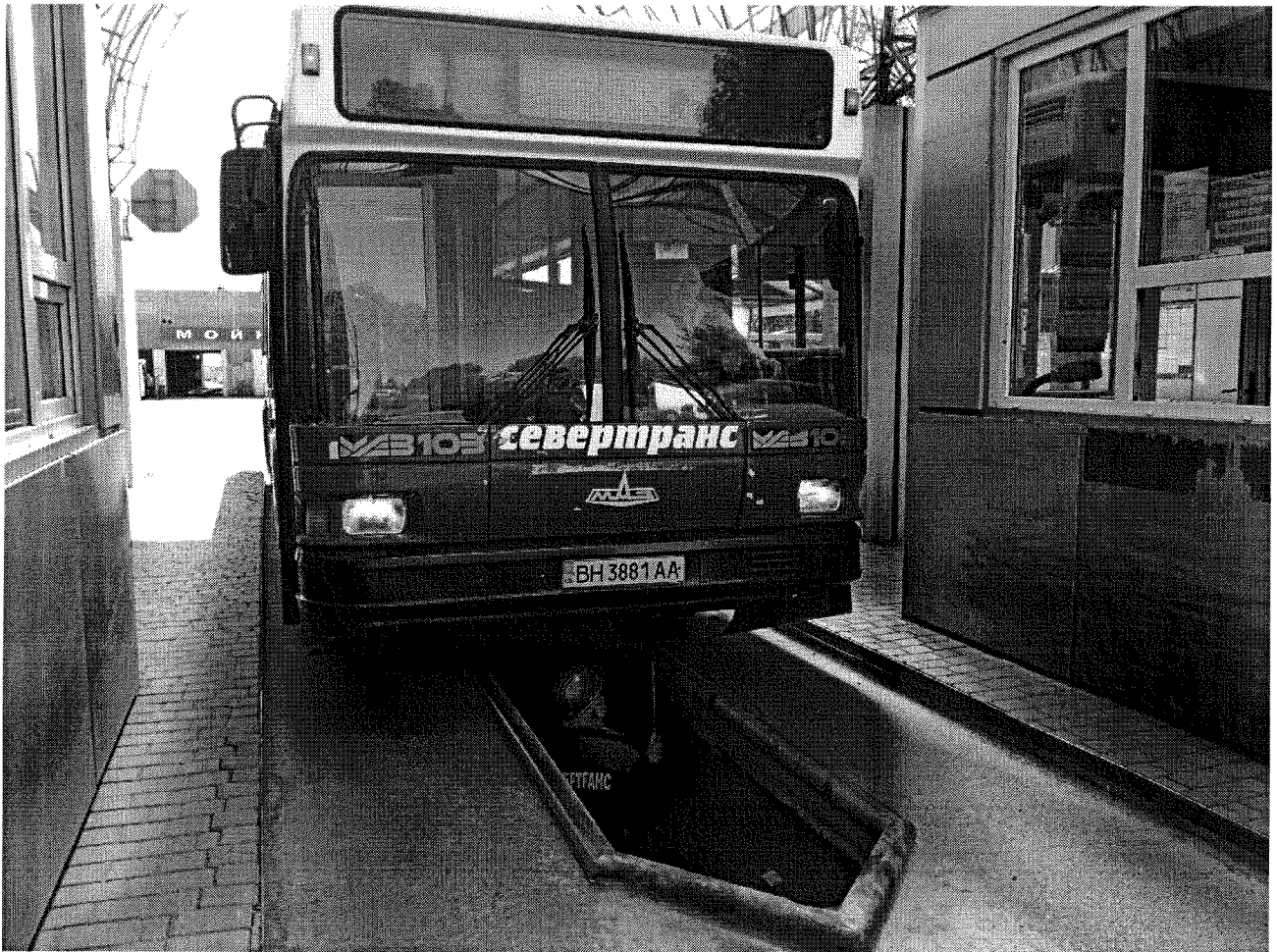
Фото 7.4 Контрольно-технічний пункт з проїзною канавою для огляду транспортних засобів.
